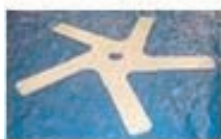
STERN MIT 5 SPEICHEN ZUR BEFESTIGUNG DER FLÜGEL
